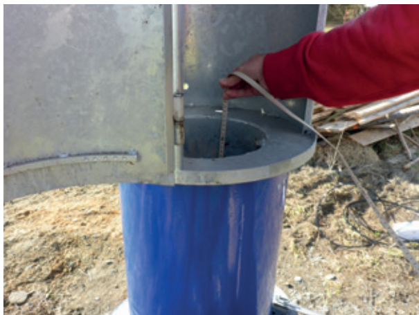
Kontrolní měření hladiny vody ve vrtech a vydatnosti pramenů. Foto: pobočka ČHMÚ Hradec Králové.
