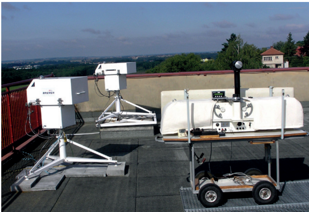
Dobsonův spektrofotometr D074 (vpravo) a Brewerovy spektrofotometry B098 a B184 (vlevo) na SOO v Hradci Králové. Foto: archiv ČHMÚ.
