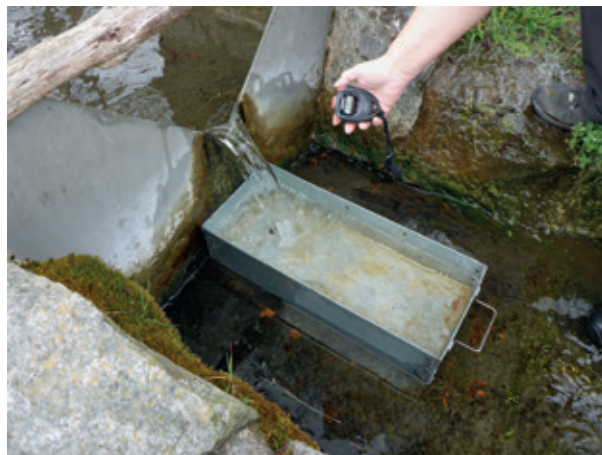
Kontrolní měření hladiny vody ve vrtech a vydatnosti pramenů. Foto: pobočka ČHMÚ Hradec Králové.
